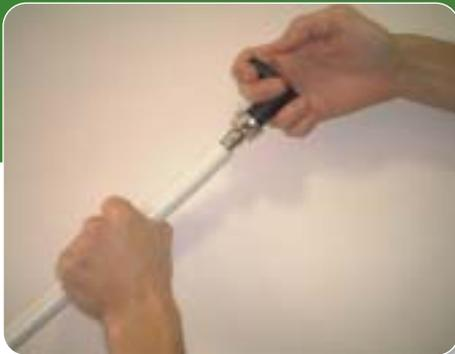
1. Corte el tubo de manera limpia y perpendicular a su eje
