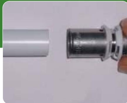
4. Posicione el lateral de la mordaza junto a la junta plástica y realice el prensado.
